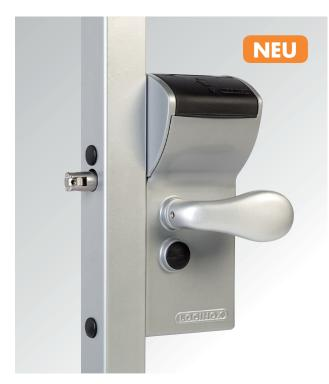
Eine Seite mit Code gesichert, andere Seite frei zugänglich. Dadurch, dass dieses Schloss arbeitet ohne Strom oder Batterie, bietet es eine einfache und schnelle Lösung für Tore mit Zugangskontrolle. Dank der 20 mm kontinuierlichen Riegelverstellbarkeit können Sie das Schloss massgenau einstellen für eine optimale Verriegelung.
